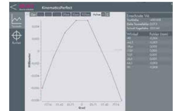
Tisch/Drehachse: Grafische Darstellung und Auswertung der C-Achse
