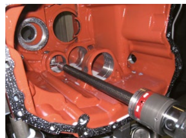
Produção seriada de caixas de cambio
