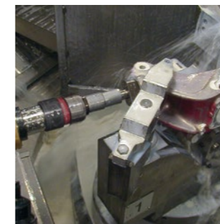
Medição de um furo de manga de eixo antes do corte
