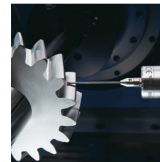
Detecção de erros de usinagem na máquina de corte de engrenagem
