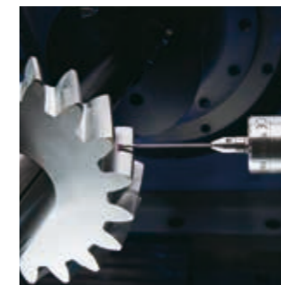
識別齒輪磨床上的加工誤差
