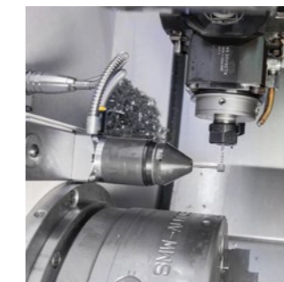
TC76 con boccola di protezione
