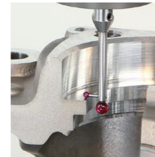
Possibilità di misure in spinta e tiro
