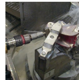
Misurazione del foro di uno snodo dello sterzo prima del taglio
