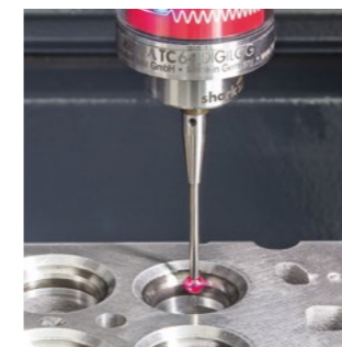
Scansione analogica del bordo dello smusso di una sede valvola
