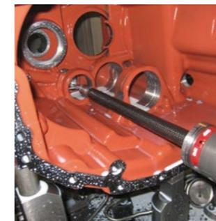
*Mesure intérieure d'un composant de turbine*
