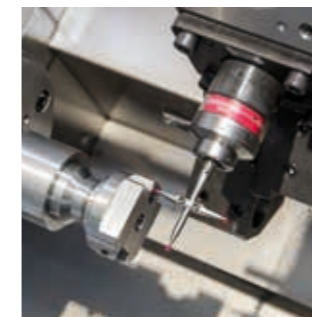
旋盤における ワーク測定
