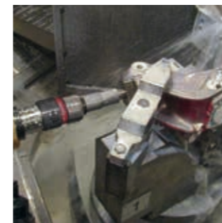
スリット加工前のステアリング ナックル測定
