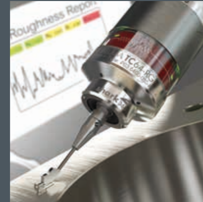
DIGILOG: マシニングセンタでの表面粗さ計測とワークスキャン
