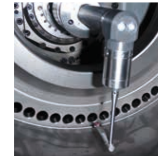
タービン部品の内部測定
