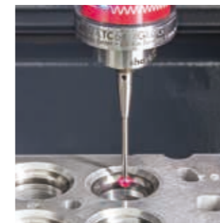
バルブシートのシール面のアナログ式 輪郭スキャン
