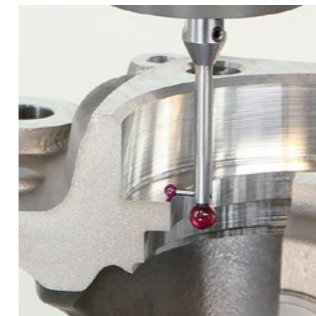
Możliwe pomiary w kierunku Z+ i Z-
