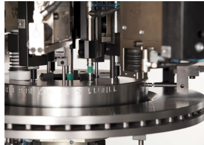
Wielopunktowe urządzenia pomiarowe
