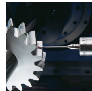
Detekcja błędów obróbki na szlifierce do kół zębatach
