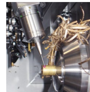
Pomiar detalu w tokarce
