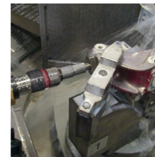
Pomiar otworu w zwrotnicy przed nacinaniem
