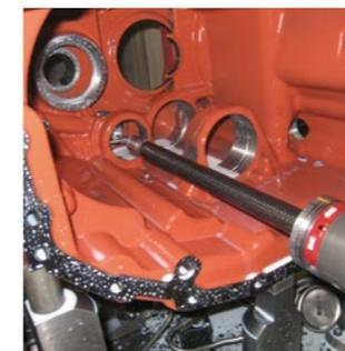
Измерение внутри конструктивного элемента турбины
