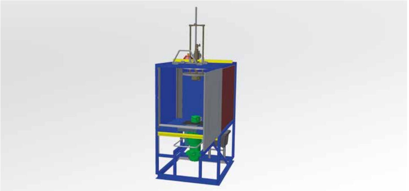
Der dynamische Impulsprüfstand ist konzeptioniert für Dauerprüfung von dynamischen Komponenten unter sehr hohem Druck bis zu 4000 bar. Die Kammer des Prüfstandes ist zusätzlich mit einer Spüleinheit für die Prüflinge ausgestattet. Die maximale Druckerzeugung bis zu 4000 bar erfolgt mit einem Druckübersetzersystem.
