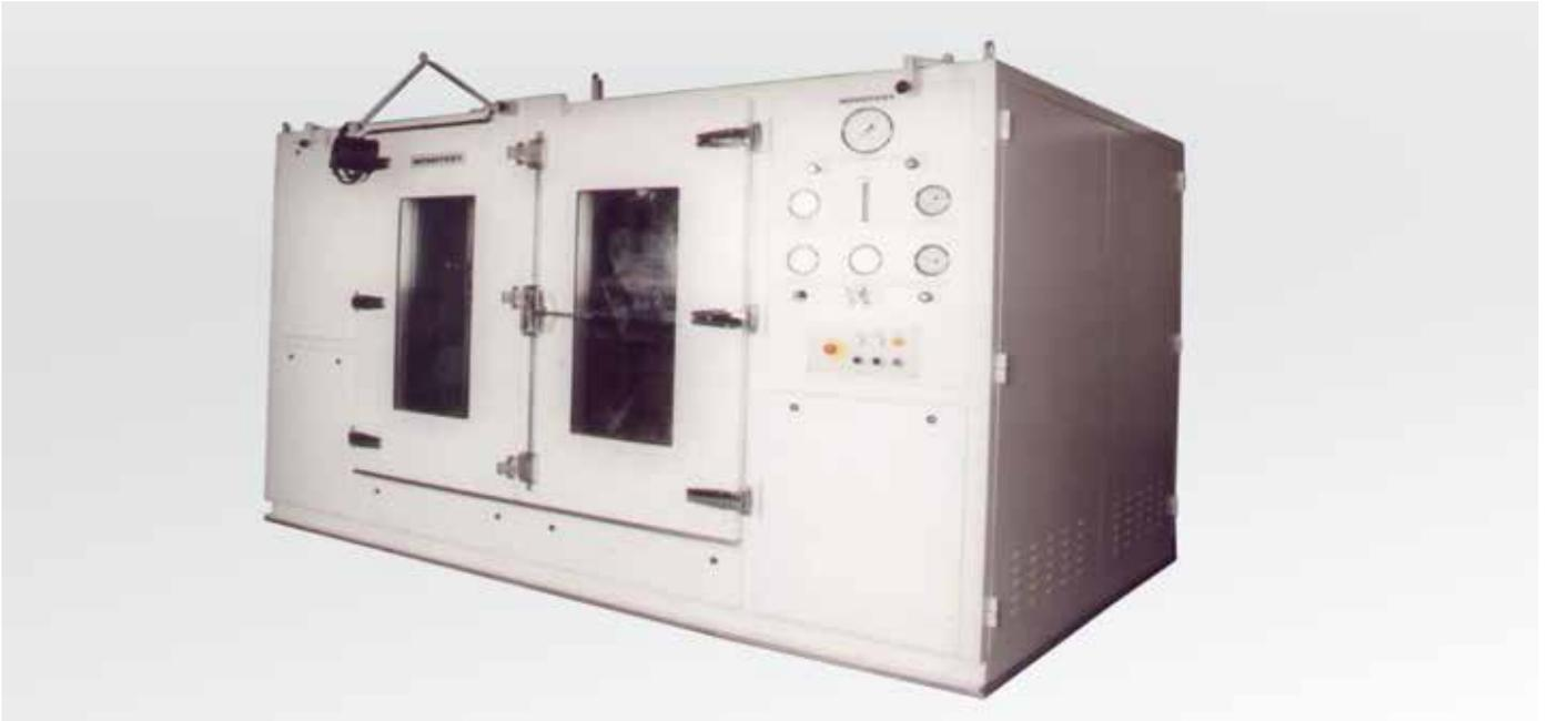
本试验台用于对冷却器进行生命周期测试。
