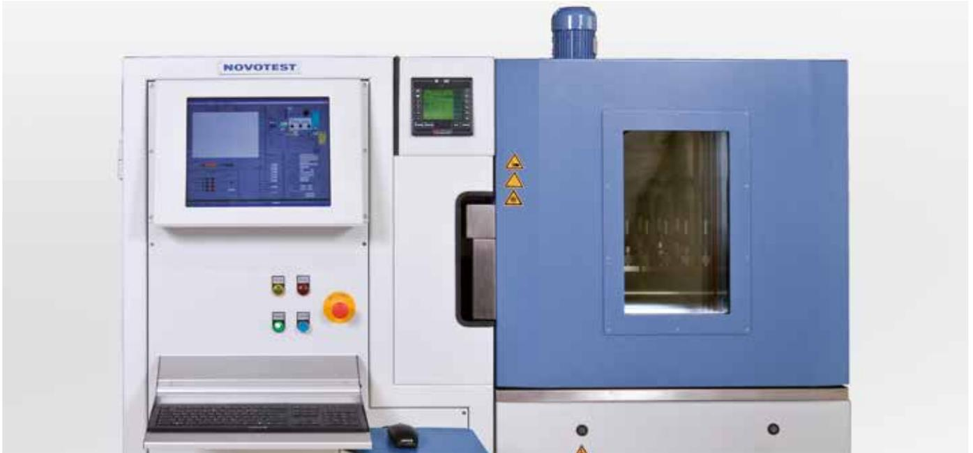
Die Impulsprüfstände der MT-Serie bieten eine kostengünstige Alternative, da es sich hier um eine modulare Lösung des Aufbaus handelt. Die Standardmaschine enthält die Basisfunktionen, die für einen Standardimpulstest nötig sind, während die Prüfumgebung erst einmal kundenseitig verbleiben kann. Der Prüfstand kann mit verschiedenen Zusatzfunktionen für speziellere Testanforderungen ausgerüstet werden.
