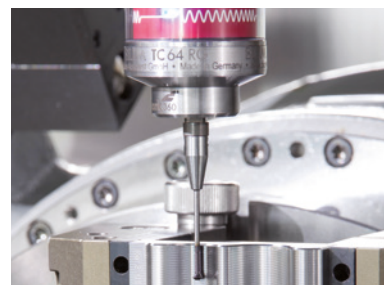
TC64-RG - マシニングセンタでの表面粗さ測定
