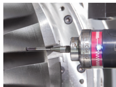
ブリス加工時の表面粗さの機上測定
