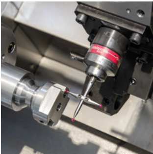
Werkstückmessung in der Drehmaschine
