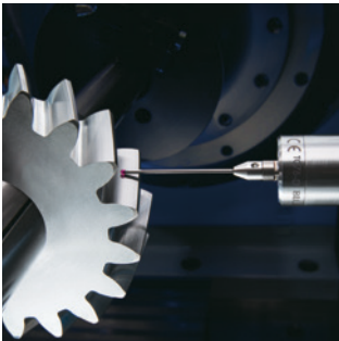
Erkennen von Bearbeitungsfehlern auf Zahnradschleifmaschine
