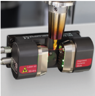
Messung von Standard- und Mikro- werkzeugen
