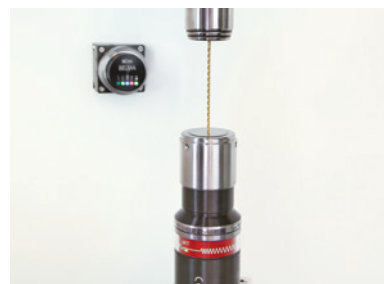
小径工具の工具長測定と折損検知
