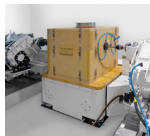
Temperaturprüfkammer für Prüfling
