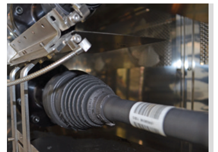
油脂泄漏监控
