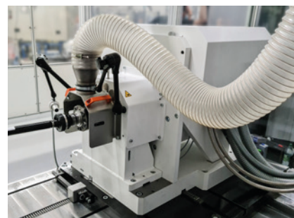
Schwenkeinheit mit Fahrwindsimulation
