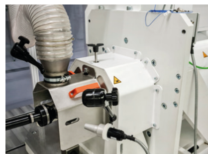
Schwenkeinheit mit Temperatursensor
